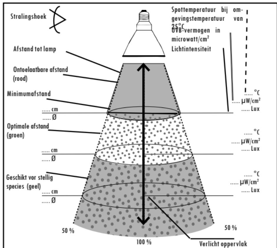
Houd er rekening mee dat de UV-hoeveelheid per bestraald oppervlak erg afhangt van de afstand tot de lamp. Bij de halvering van de afstand verviervoudigt zich in theorie de bestralingssterkte en vice versa. Bij een afstand van 20 cm is de UV-dosis dus viermaal hoger dan bij 40 cm. Voor de veiligheid van uw dieren dient u daarom de afstanden strikt te handhaven.
