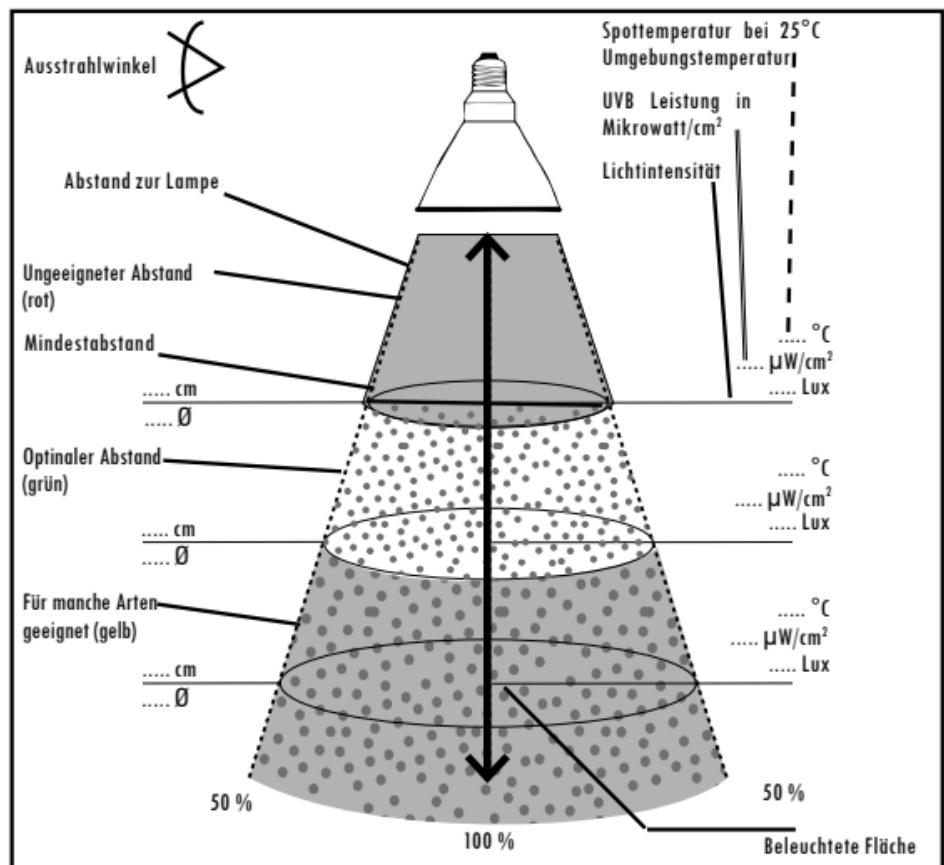
Bitte beachten Sie, dass die UV-Menge pro bestrahlter Fläche sehr stark von der Entfernung zur Lampe abhängt. Bei der Halbierung der Entfernung vervierfacht sich theoretisch die Bestrahlungsstärke und umgekehrt. Bei 20 cm Abstand ist die UV Dosis also viermal so hoch, wie bei 40 cm. Aus diesem Grund sollten zur Sicherheit Ihrer Tiere die Angaben zu Abständen unbedingt eingehalten werden!
