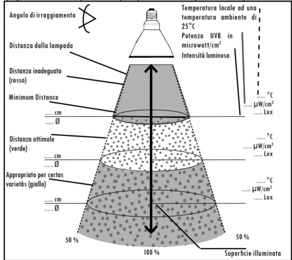
stanza dalla lampada. Dimezzando la distanza si quadruplica teoricamente la potenza di irraggiamento e viceversa. Ad una distanza di 20 cm la dose di UV è quindi quattro volte superiore, come a 40 cm. Per questo motivo è necessario rispettare scrupolosamente le indicazioni sulle distanze, per la sicurezza dei vostri animali!
