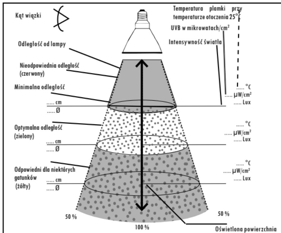
Należy pamiętać, że ilość promieniowania UV na oświetlanej powierzchni będzie w dużym stopniu zależeć od odległości od lampy. Zmniejszenie odległości o połowę spowoduje czterokrotne zwiększenie ilości promieniowania UV i odwrotnie. W odległości 20 cm wydajność UV jest 4 razy wyższa niż w odległości 40 cm. Z tego powodu należy wziąć pod uwagę nasze zalecenia dotyczące odległości dla bezpieczeństwa zwierząt.
